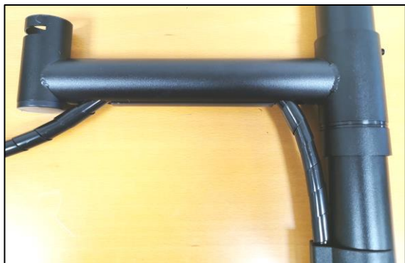
Abb. 19 – Komplette Kabelführung; wenige Kabel.
