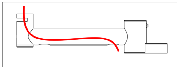
Abb. 28 – Kabel am Arm; Innen von innen.
