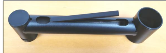
Abb. 14 – Arm Abdeckung entfernen.
