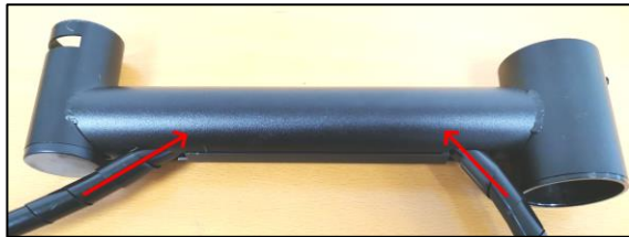
Abb. 18 – Kabelummantelung nach innen.
